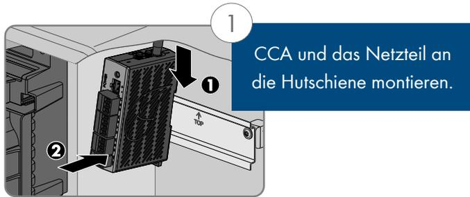
1 CCA und das Netzteil an die Hutschiene montieren.
