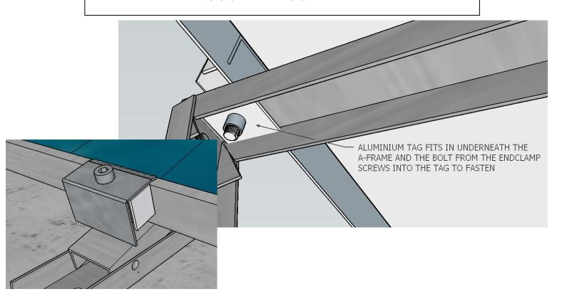
INSTALL THE END CLAMP BY SLIDING THE TAG UNDER THE A-FRAMES FRAME AND FATEND THE BOLT ONTO THE TAG FROM ABOVE. MAKE SURE THE ALUMINIUM SPACER IS PRESSED AGAINST THE PANEL WHEN FASTENING THE END CLAMP.
