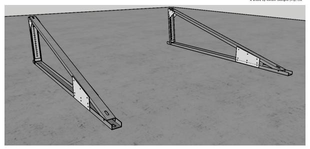
SPACE YOUR 2 A FRAMES UNDER THE CLAMPING ZONES OF THE SOLAR PANEL
