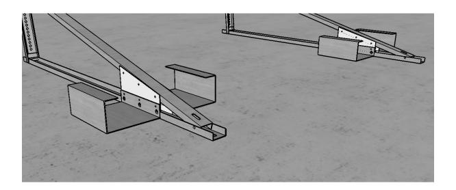
INSTALL THE FRONT BALLAST HOLDERS BY POPRIVETING THEM TO THE GUSSET ON THE FRONT OF THE A-FRAME.
