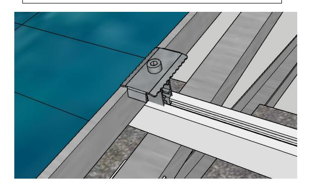
INSTALL THE MID CLAMP BY CLIPPING THE PUSH CLIP INTO THE RAIL. MAKE SURE THE SPACER IS PRESSED AGAINST THE PANEL WHEN FASTENING THE MID CLAMPS. **TIGHTEN TO 8Nm**
