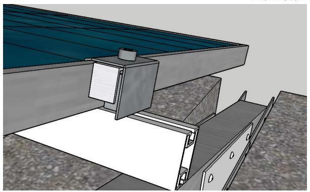
INSTALL THE END CLAMP BY CLIPPING THE PUSH CLIP INTO THE RAIL. MAKE SURE THE ALUMINIUM SPACER IS PRESSED AGAINST THE PANEL WHEN FASTENING THE END CLAMP. **TIGHTEN TO 8Nm**
